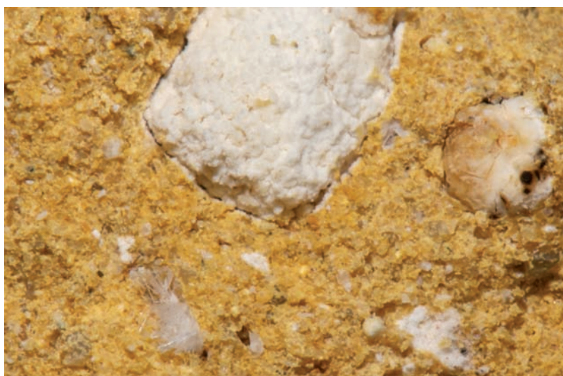
Fig. 3: Macro-opname van de gele mortel. Overvloedig kwartzand van 0,1 tot 0,5 mm. Fijn verdeelde kalk van 0,1 tot 0,3 mm en regelmatige, grotere brokken kalk tot 5 mm. Sporadisch naaldvormige kristalgroei (onderaan links). De breedte van de foto bedraagt 1 cm (© J. De Beenhouwer).
